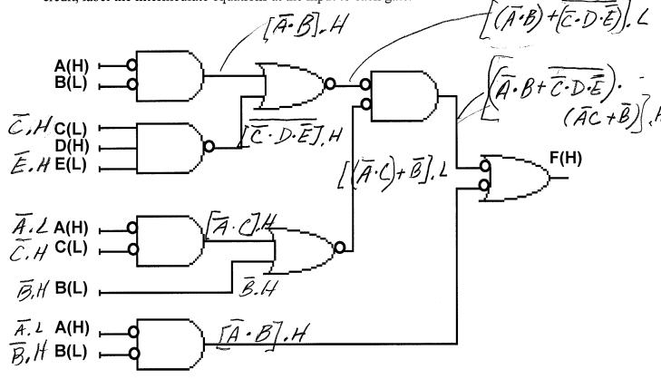
$$F = \overline{(\overline{A} \cdot B + \overline{c} \cdot D \cdot \overline{E}) \cdot (\overline{A}C + \overline{B})} + \overline{\overline{A} \cdot B}$$
