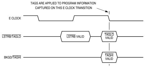
Figure 8-9. Tag Input Timing
